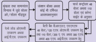
चित्र क्रं. 1 : सोलर फोटो वोल्टाइक प्रणाली का खण्ड रेखाचित्र
